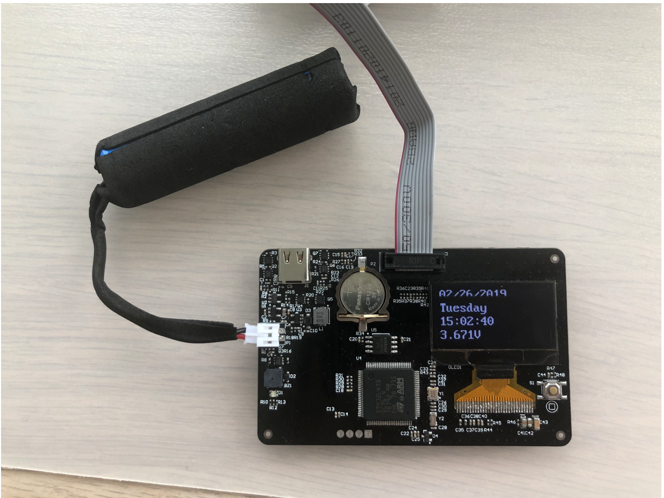
控制板左侧设有上、中和下三个电容触摸按键，右侧设有一个返回实体按键，按任意键进入主菜单。
