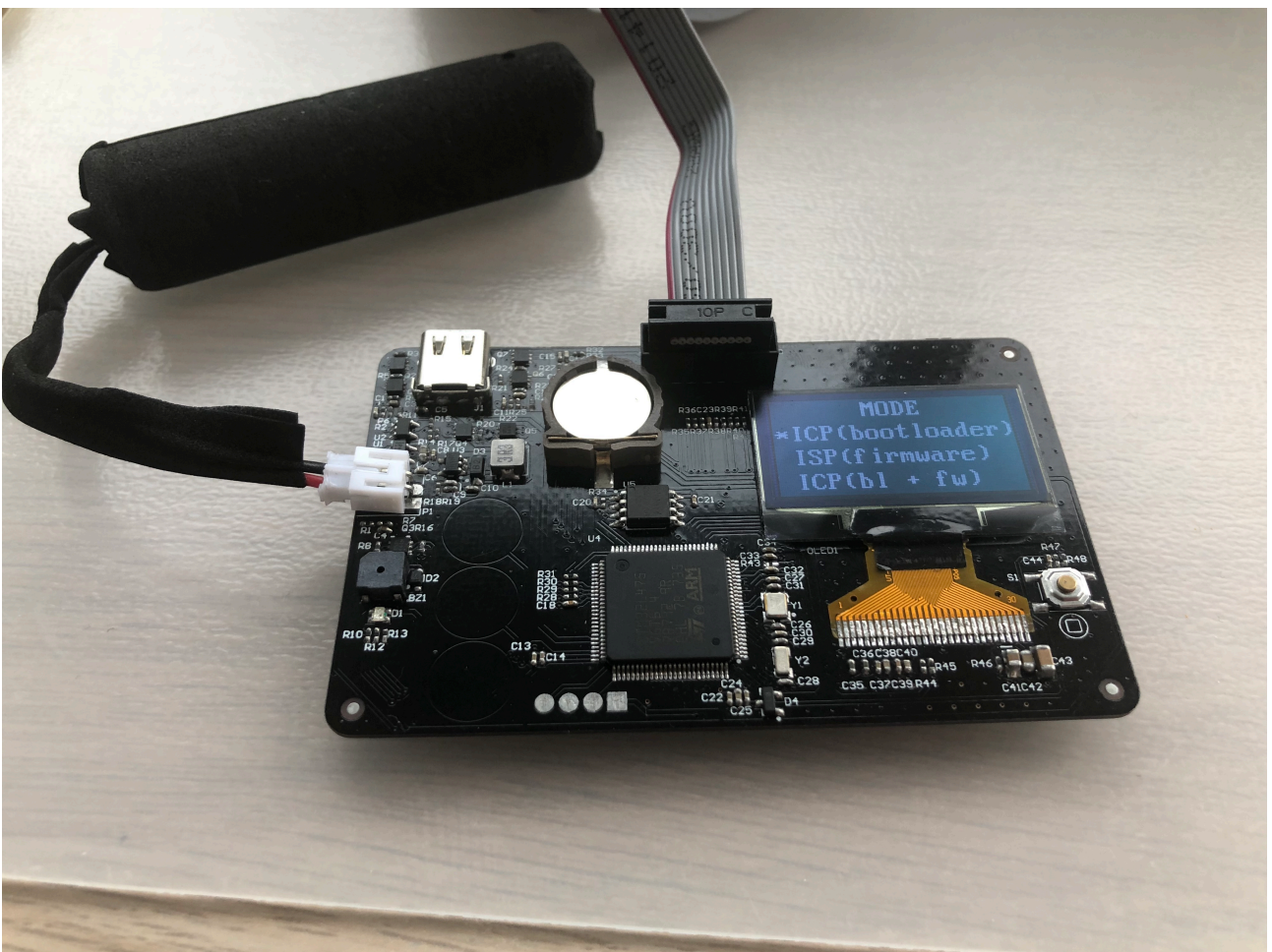
控制板左侧设有上、中和下三个电容触摸按键，右侧设有一个返回实体按键，按任意键进入主菜单。
